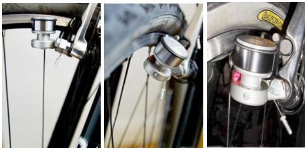
Bremssockel-Adapter links mit justierbarer Kugelaufgabe, Anbausituation, Winkelung, Achsenstand: Grundstellung, abgeklappt, Arbeitsstellung angeklappt
