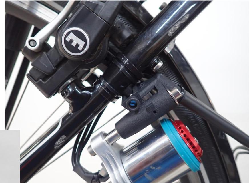
11. Seilzug vormontieren: Bei langer Pendelachse (üblicherweise am langen 3135-Motor) liegt der Seilzug zwischen den oberen beiden Rippen der Motorbasis, bei kurzer Pendelachse zwischen den beiden unteren. Außen wird das Seil durch einen Splint in der Seilschlaufe gehalten, innen verhindert ein zweiter Splint das Abrutschen des Seils aus der Nut.
