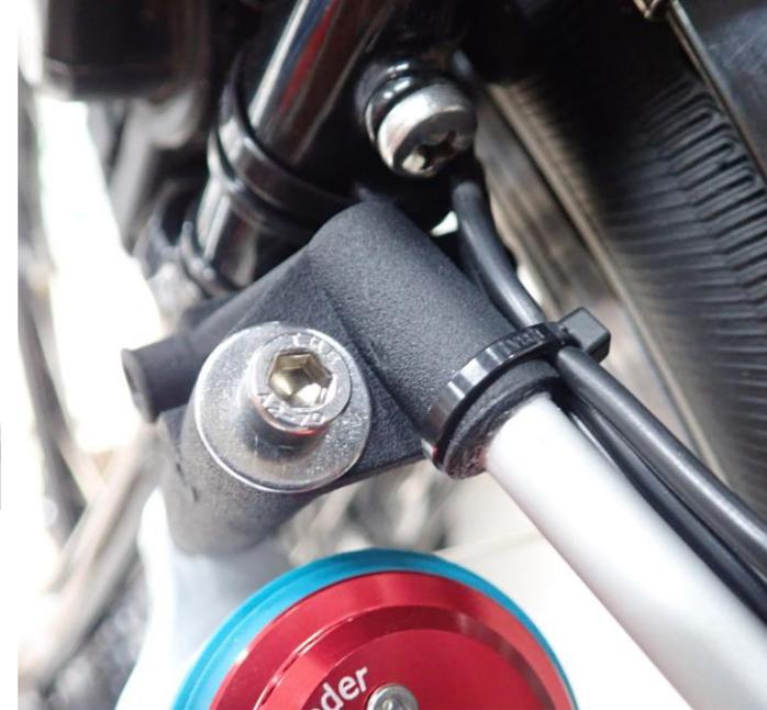
10. Den großen Schrumpfschlauch so zuschneiden, dass er den blanken Abschnitt des Stützstabs zwischen Motorhalter und Schelle abdecken kann. Schelle abnehmen, Motorkabel kreuzungsfrei durch Schrumpfschlauch fädeln, Schrumpfschlauch über Stützstab schieben. Schelle anbringen und festziehen (1Nm). Innen und kreuzungsfrei liegende Motorkabel mit Heißluftfön festschrumpfen.
