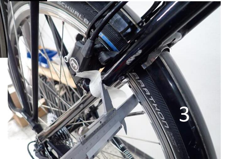
3. Sattelstrebe (2) im Felgenbereich entfetten, um sichere Haftung des Variohalters zu gewährleisten (Tipp: Waschbenzin entfettet sehr gut und greift die meisten Lackierungen nicht an.)
