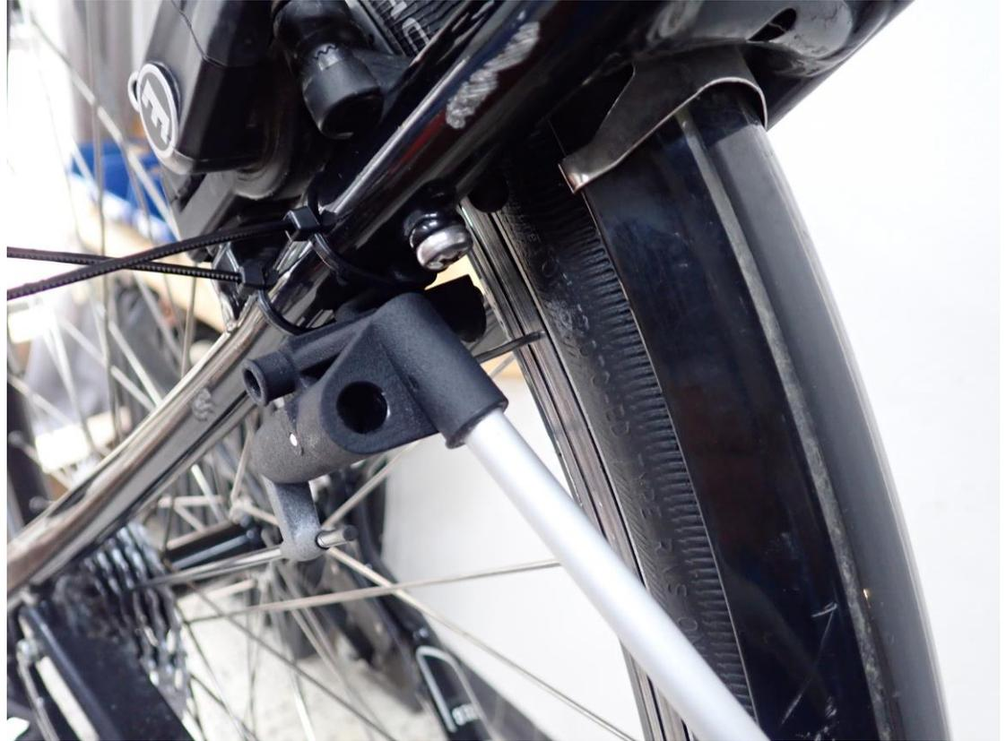
7. Einbaulänge beider Stützstäbe sowie die Position beider Strebenauflagen markieren. Um spätere Korrekturen zu ermöglichen sollen die Stützstäbe nicht bündig, sondern mit 10mm Überlänge abgesägt werden. Dazu werden die Schellen losgeschraubt, die Kabelbinder der Strebenauflage durchtrennt und beide Halter abgenommen.
