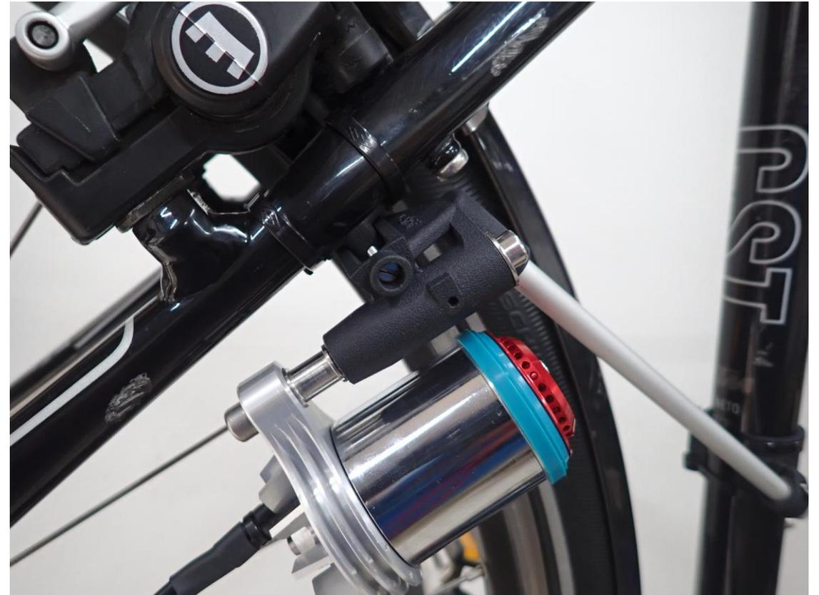
9. Motor mit rotem Stecker links, den anderen rechts einsetzen und Pendelachsschrauben nur leicht anziehen. Gebogene Messingröhrchen nach oben klappen. Motorkabel in einer Schlaufe kreuzungsfrei nach oben und eng an Strebenaufgabe/Motorhalter anliegend innen vorbeiführen und mit kleinen Kabelbindern fixieren.
