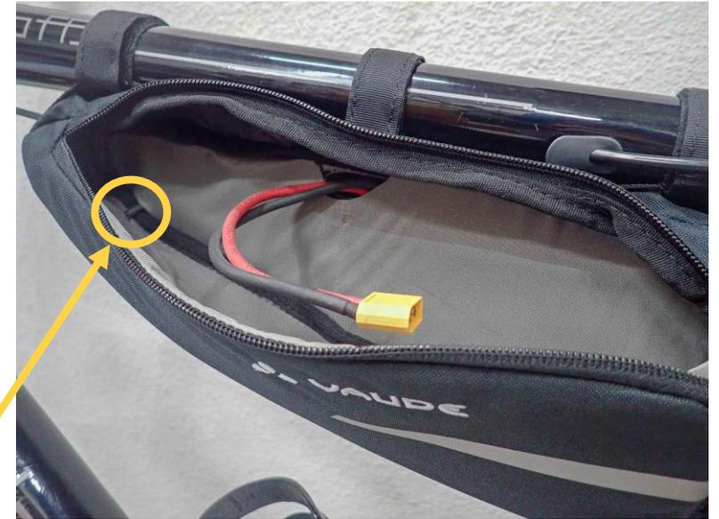
Potileitung S-förmig durch die vorderen Schlaufen zur Zugentlastung
