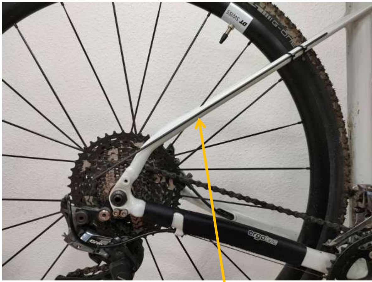
gerader (Carbon)-Stab als Verlängerung der Strebenachse
