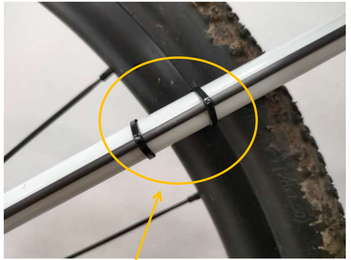
geraden Stab auf Höhe der Felge in der Mitte der Sitzstrebe befestigen
